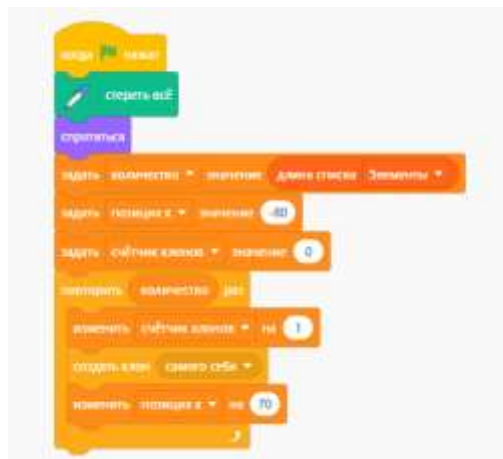
Рис. 5. Скрипт для создания клонов столбика
