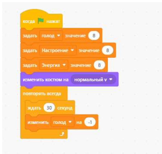
Рис. 6. Скрипт инициализации. При запуске проекта переменные получают значение 8, питомец принимает нормальный вид, а затем каждые 30 секунд голод уменьшается на 1.
