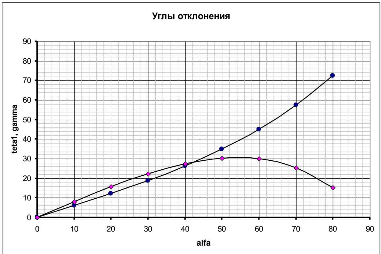
**2.8** Зависимость угла  $\gamma$  от угла падения на каплю имеет точку максимума. Вблизи экстремума происходит резкая концентрация лучей, поэтому в отраженном свете хорошо видна яркая граница отраженных лучей. Угол отклонения преломленных лучей экстремумов не имеет, поэтому резких ярких полос в проходящем свете не наблюдается.
