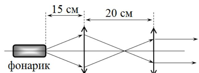
**1.6** Оптическая схема для получения спектра на экране показана на следующем рисунке.
