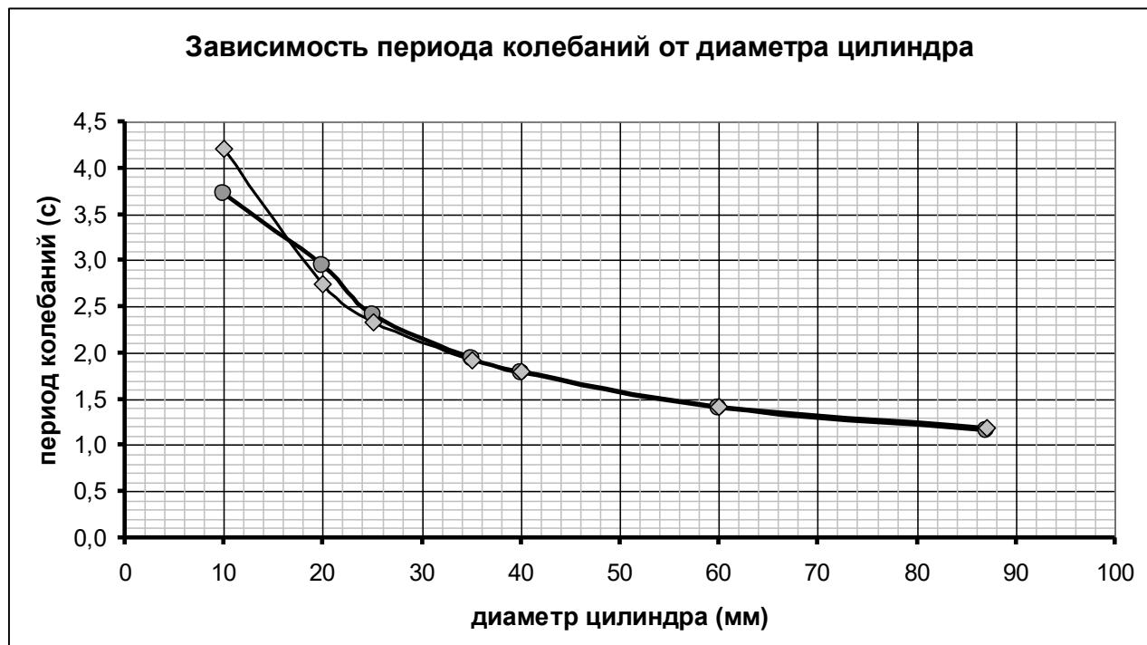
**1.4** Линеаризация зависимости (1), приведенной в условии задачи достигается очевидным способом: необходимо построить зависимость величины  $z = T^{-2}$  от диаметров цилиндров. Этую зависимость можно представить в виде
