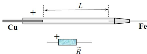
Для заполнения трубки раствором кислоты извлеките медный провод из трубки, опустите толстый конец трубки в стакан с раствором и, всасывая воздух через тонкий конец трубки (не доставая стальной проволоки), заполните трубку.
