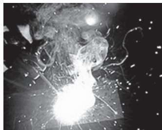
Рис. 4.5. Горение металлов при кислородной резке стали — резка «кислородным копьем»
