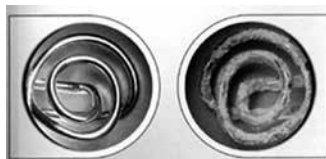
Рис. 10. Новый тэн и тэн после 6 месяцев эксплуатации
