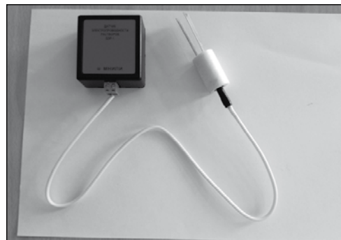
Рисунок 14 — Датчик электропроводности растворов с зондом (1) — две параллельные металлические пластинки (электроды)
