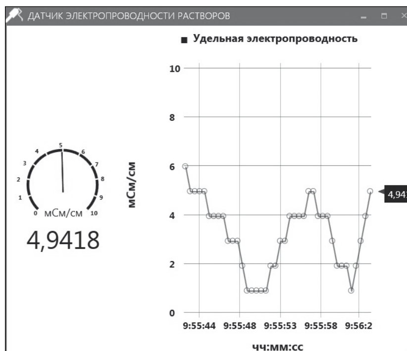
Рисунок 3 — Окно «Датчик электропроводности растворов». Стрелочный индикатор отображает текущее значение удельной электропроводности раствора 2 , ниже — цифровое значение удельной электропроводности раствора (в миллисименсах на сантиметр); справа — график зависимости значения удельной электропроводности от времени наблюдения
