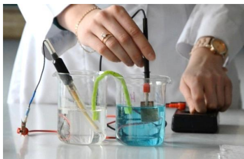
Рис. 9. Фотография и схема измерения электродных потенциалов: 1 – исследуемый электрод; 2 – хлорсеребряный электрод сравнения; 3 – солевой мостик; 4 – стакан с раствором электролита; 5 – стакан с насыщенным раствором KCl; 6 – измерительный прибор
