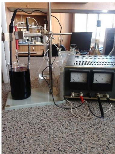
Рис. 11. Фотография и схема прибора для окрашивания поверхности анодированного алюминия: 1 – источник питания переменного тока (можно использовать ЛАТР), 2 – ванна с электролитом, 3 – мультиметр (ампервольтметр), 4 – электрод с анодированным алюминием, 5 – графитовые электроды.
