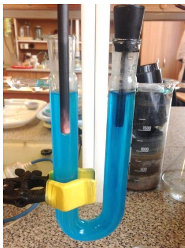
Рис. 7. Осажденная медь на графитовом электроде после проведения электролиза раствора сульфата меди (II)
