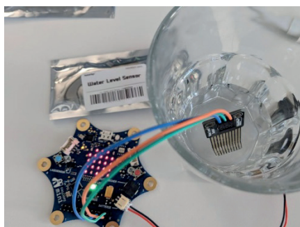
Рис. 4. Датчик уровня воды
