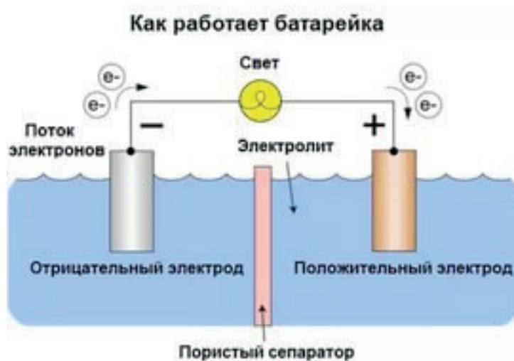
Рис. 11. Принцип работы батарейки
