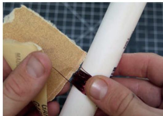
Рис. 38. Наматывание проволоки на трубку
