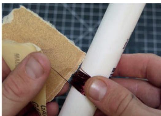
Рис. 38. Наматывание проволоки на трубку
