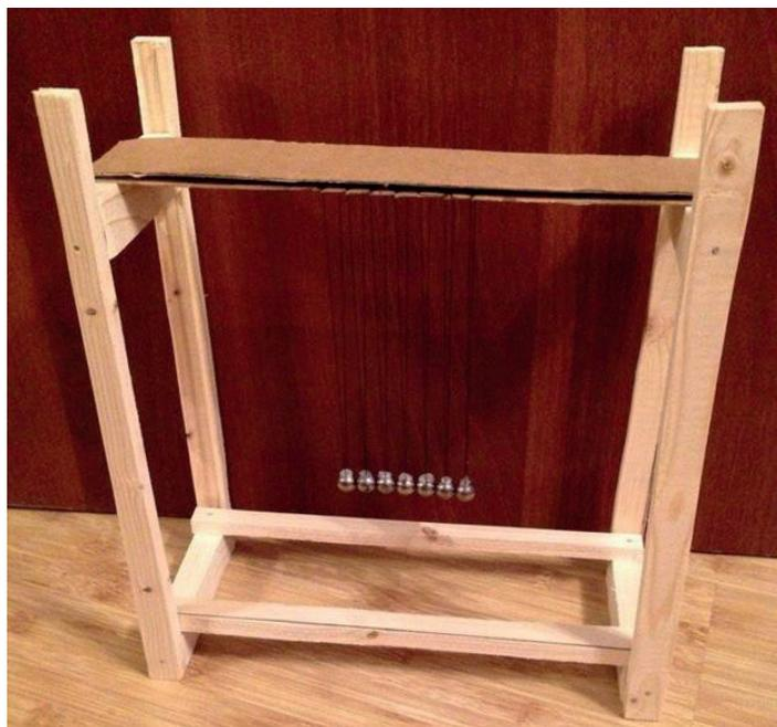
Рис. 48. Прибор для демонстрации закона сохранения импульса
