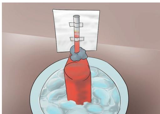
Рис. 36. Проверка работы самодельного термометра
