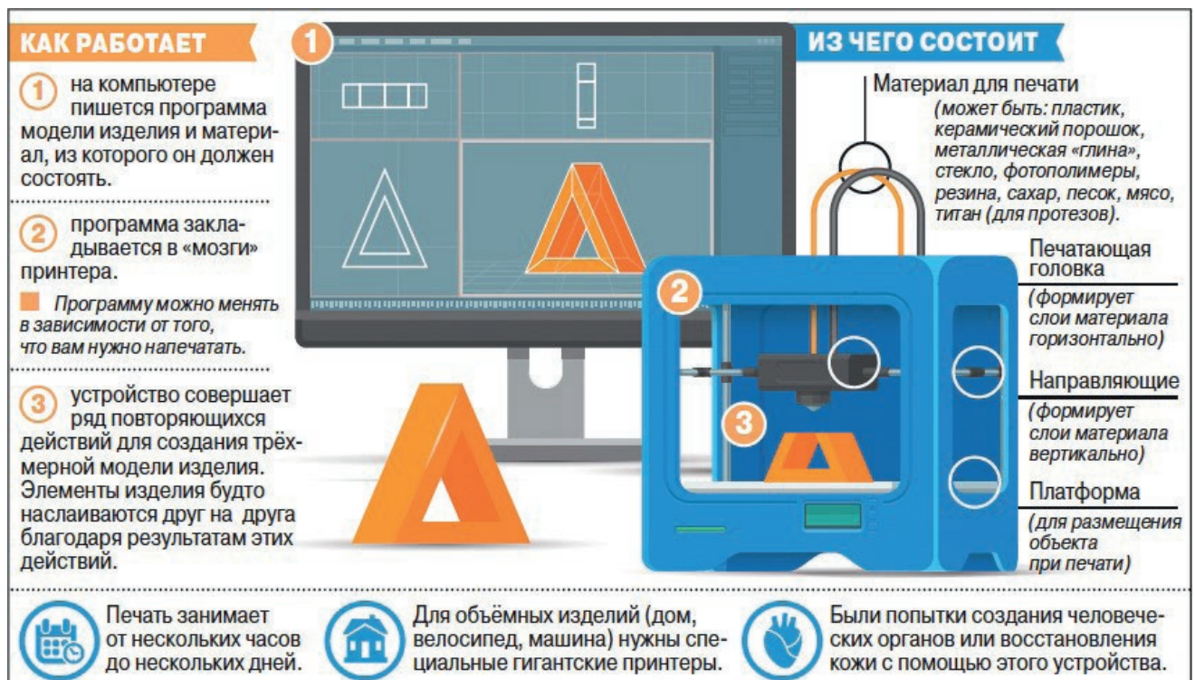
Рис. 24. Как работает 3D-принтер
