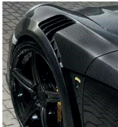
Рис. 20. Применение карбона в автомобилестроении
