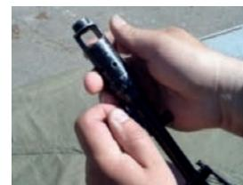
8. Отсоединяет крышку ствольной коробки
