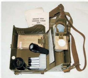
Рис. 75. Войсковой прибор химической разведки
