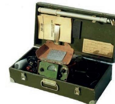
Рис. 72. Измеритель мощности дозы ДП-5В
