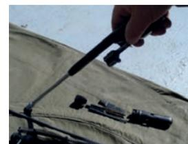
10. Отсоединяет газовую трубку со ствольной накладкой
