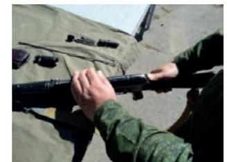
7. Отсоединяет дульный тормоз-компенсатор
