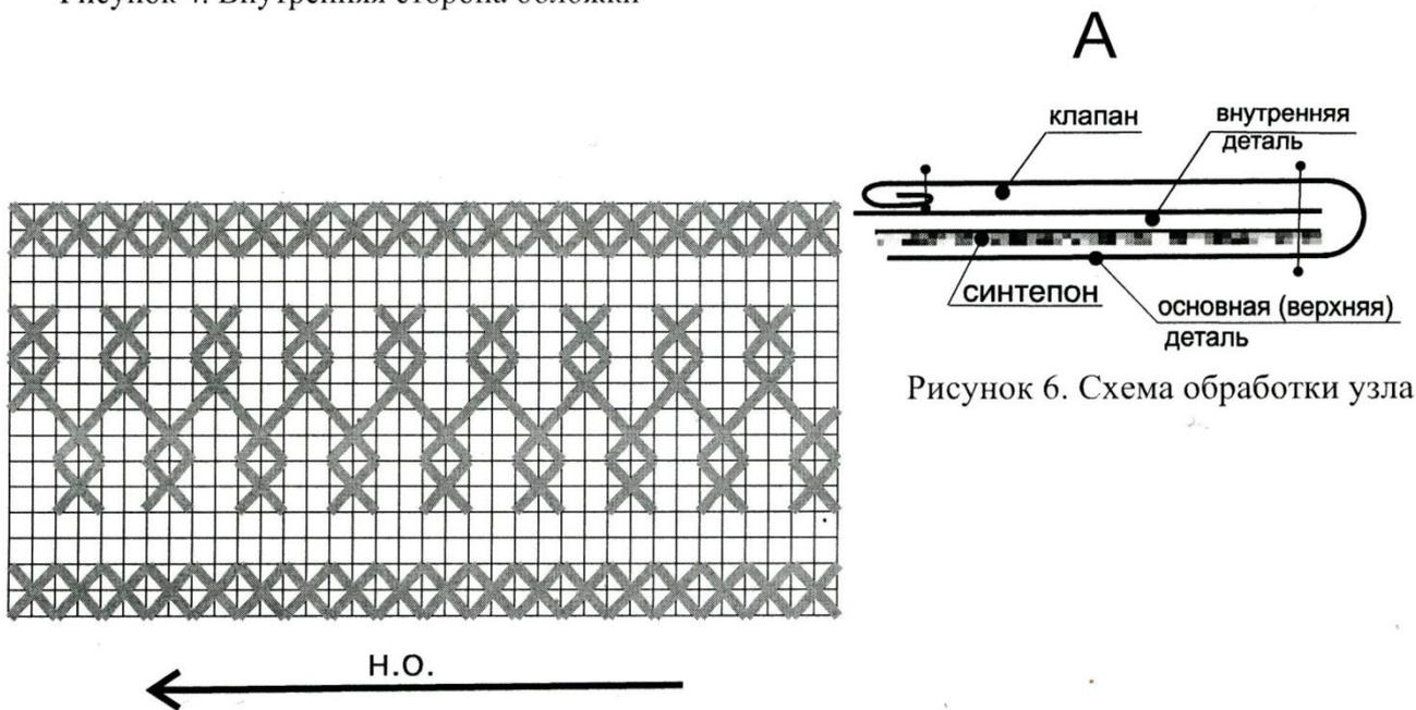
Рисунок 6. Схема обработки узла
