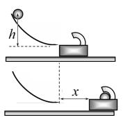
Случай В. Шарик попадает внутрь коробки и остается в ней (этот процесс мы также называем ударом). Для этого из пластилина можно сделать выемку, не позволяющую шарику выскочить из коробки. Объем пластилина в обоих случаях должен быть одним и тем же.
