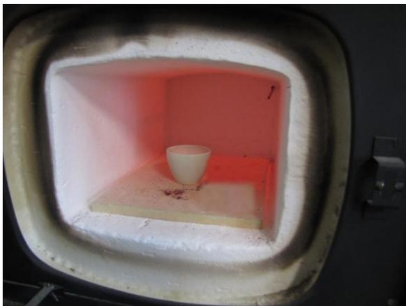
Рисунок 5.1 Нагревание железных стружек в открытом тигле
